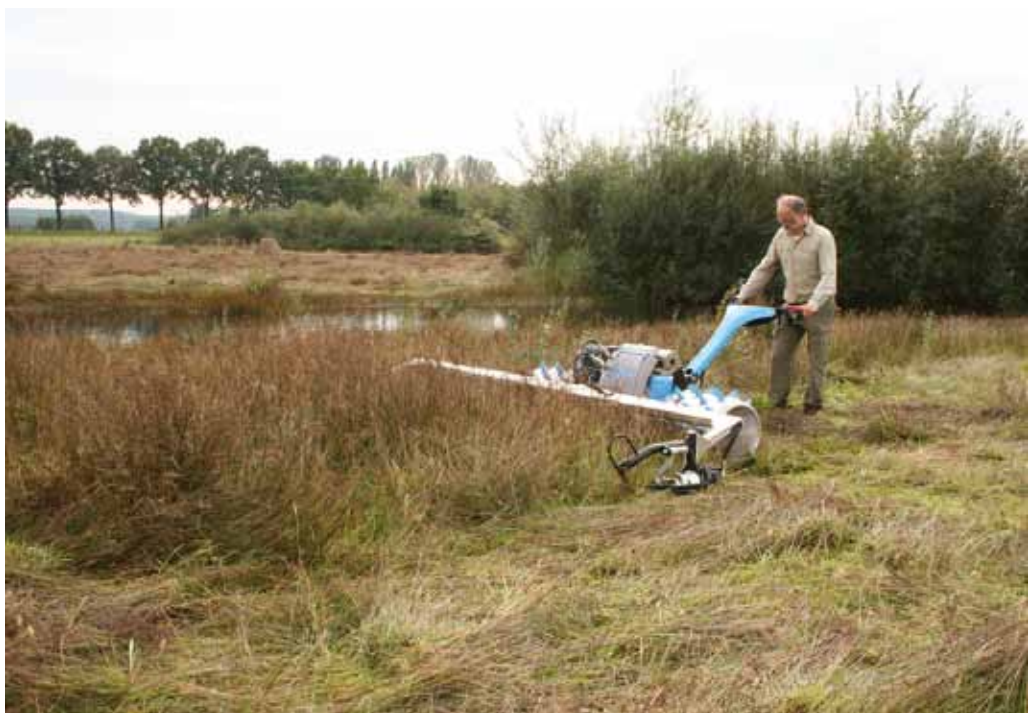
De gepatenteerde kunststof noppenwalsen waarop de machine rijdt, zijn verkrijgbaar in 3, 4 of 5 rijige uitvoering.
